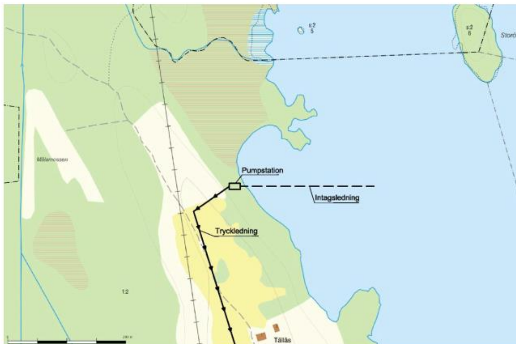
Figur 7. Översikt planerad intagsledning och pumpstation i Försjöns nordvästra del (Vatten och Samhällsteknik, 2020). Norr är uppåt i figuren.
